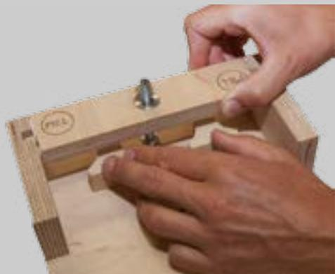
Die Mitte der FüÙe anzeichnen und die konische Halterung (MEL) der FüÙe anpassen und nach Markierung einspannen - bohren sie nun mit dem Forstner Bohrer (MFBN) exakt 15mm tief
